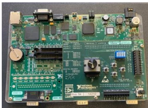
National instruments Single-Board RIO, робототехническая транспортная платформа
